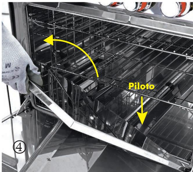
Abra la puerta del horno, levante y quite la tapa del piso del horno y podrá ver el tubo del piloto.
